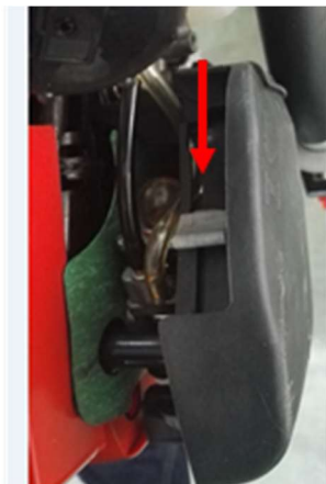
Startklappe geschlossen (Startklappenhebel weg vom Kraftstofftank)
