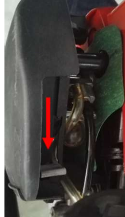
Kłapa startowa otwarta (dźwignia kłapy startowej w dół)
