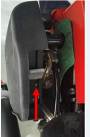
Sportello di avvio chiuso (leva dell'aletta di avviamento verso l'alto)
